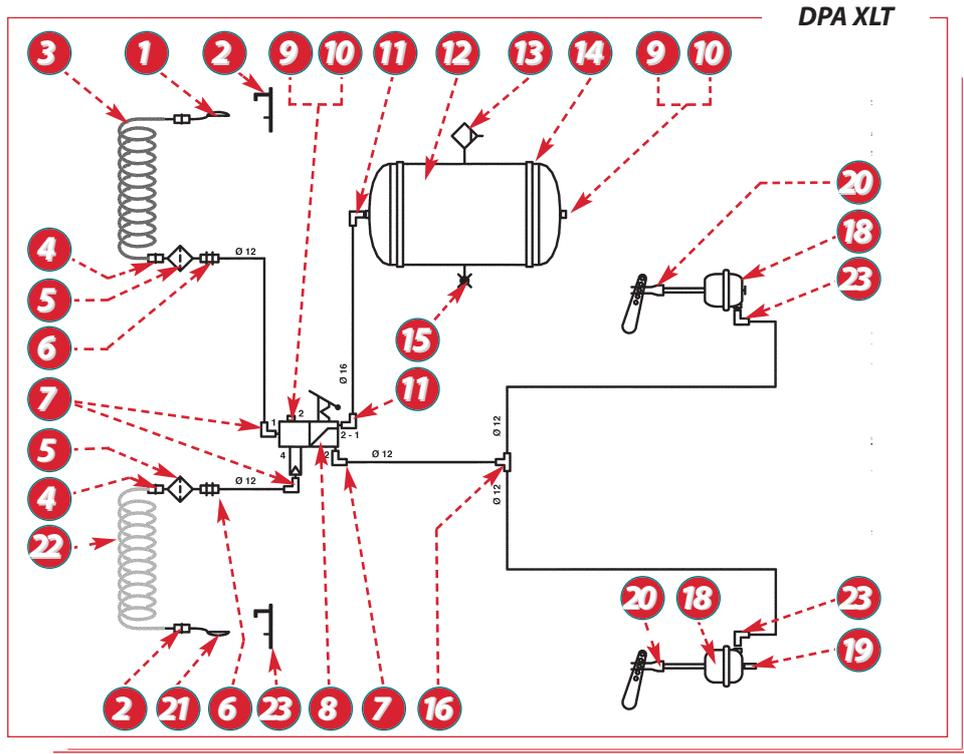
**Commande pneumatique de freinage**
