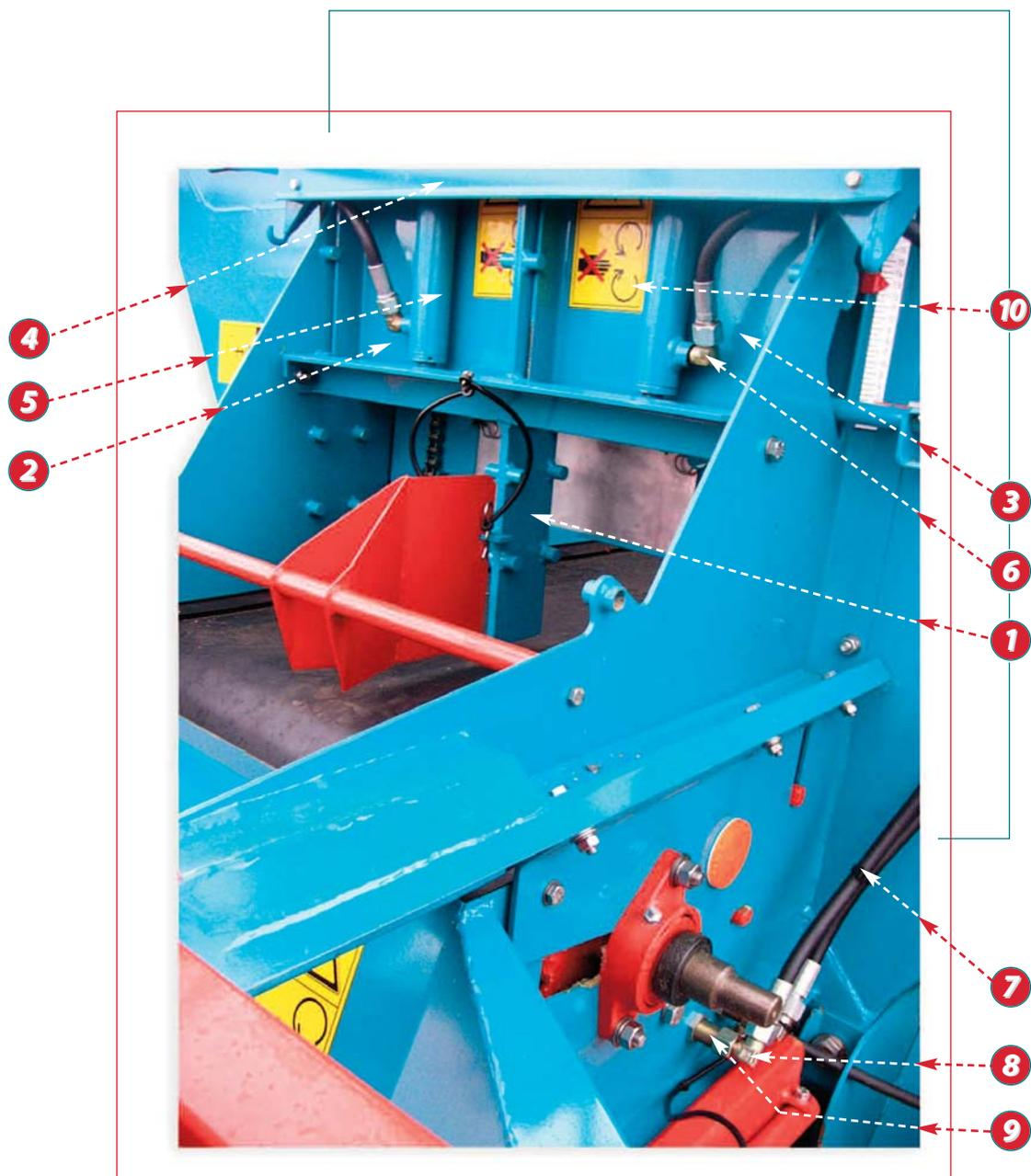
**Trappe double à commande hydraulique**
