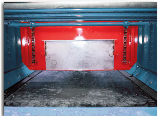
TRAPPE GUILLOTINE EN POSITION REPOS
